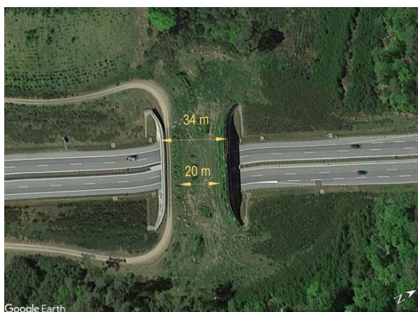
Ryc. 4.36. Bardzo dobrze zagospodarowane przejście zespolone (szerokość obiektu wynosi 34 m, a faktyczna szerokość przejścia – 20 m) Źródło: zdjęcie satelitarne z Google Earth [163].
