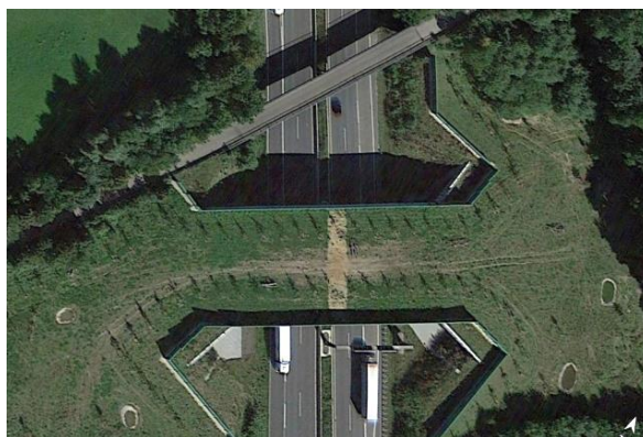
Ryc. 4.86. Rezultaty stopniowo wykonywanych prac rewaloryzacyjnych mających na celu uzupełnienie nasadzeń drzew, budowę oczek wodnych w strefie migracji i najścia, związanych m.in. z zapewnieniem ciągłości tras przelotu nietoperzy Źródło: zdjęcie satelitarne z Google Earth [163].
