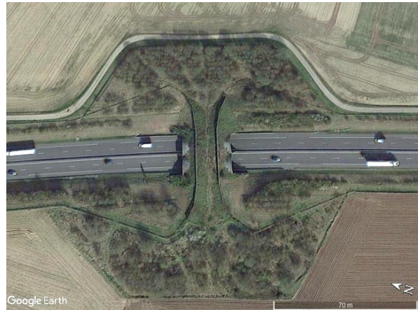
Ryc. 4.45. Zagospodarowanie przejścia, o szerokości 12 m, wybudowanego w terenie rolniczym, z wyraźnie wydzielonymi najściami w strefie buforowej Źródło: zdjęcie satelitarne z Google Earth [163].
