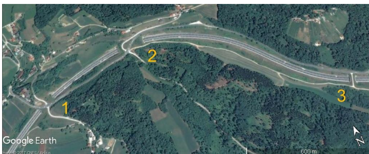
Ryc. 2.49. Trzy kolejne przejścia – od lewej: Modvedjek I (szerokość 98 m), Modvedjek (szerokość 159 m) i Dolge dole (szerokość 44 m), wybudowane w Słowenii nad autostradą A2 na długości 1,8 km Źródło: zdjęcie satelitarne z Google Earth [163].
