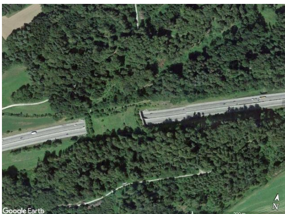
Ryc. 4.52. Most krajobrazowy, o szerokości faktycznej 110 m, z prawidłowo zagospodarowaną strefą migracji Źródło: zdjęcie satelitarne z Google Earth [163].
