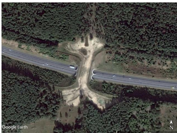
Ryc. 3.42. Strefa buforowa na moście zielonym wybudowanym nad autostradą A1 w Holandii, koło wsi Udel Źródło: zdjęcie satelitarne z Google Earth [163].
