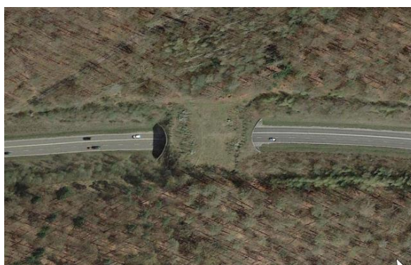
Ryc. 4.84. Przykład zmiany zagospodarowania terenu przejścia i samoistnego ekspansyjnego rozwoju okolicznej roślinności na powierzchni przejścia, wałach ziemnych i skarpach wykopu, odgradzających najścia na obiekt Źródło: zdjęcie satelitarne z Google Earth [163].
