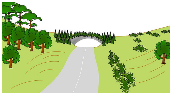
Ryc. 3.14. Zalecana niweleta przejścia górnego skonfigurowana w łuku pionowym wklęsłym Źródło: opracowanie graficzne Dominik Kacprzak.
