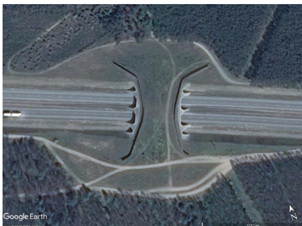
Ryc. 5.2. Powierzchnia wykarczowanego lasu przy przejściu zespolonym i nieprawidłowe lokalizacje dróg w części południowej (autostrada A2 w Polsce, koło wsi Teresin) Źródło: zdjęcie satelitarne z Google Earth [163].
