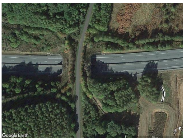
Ryc. 2.21. Przykład uwzględnienia warunków krajobrazu hydrograficznego na przejściu wybudowanym we Francji nad autostradą A89, w pobliżu wsi Augère Źródło: zdjęcie satelitarne z Google Earth [163].
