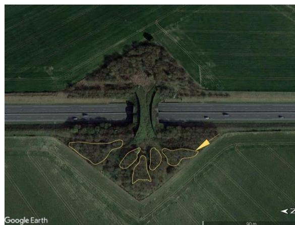
Ryc. 5.14. Przykład bogatego zagospodarowania stref przywabiania i szczelnego ich połączenia z nasadzeniami na skarpach wykopu, przy pozostawieniu strefy migracji obsianej tylko trawą i ziołami Źródło: zdjęcie satelitarne z Google Earth [163].
