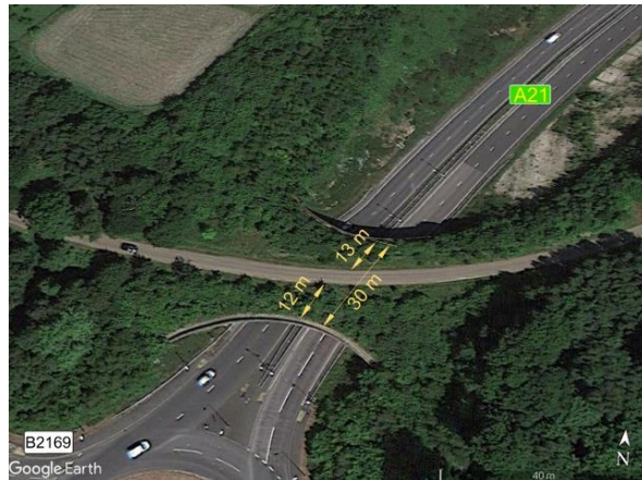
Ryc. 4.23. Zagospodarowanie przejścia zespolonego wybudowanego nad autostradą A21 w Wielkiej Brytanii Źródło: zdjęcie satelitarne z Google Earth [163].
