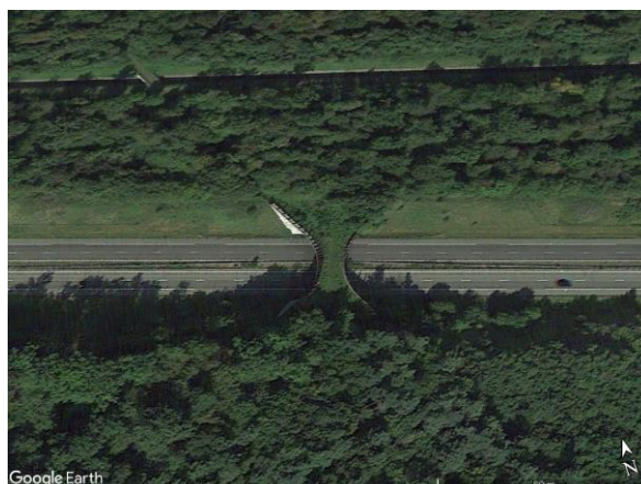
Ryc. 2.35. Czwarte od zachodu przejście górne, z drogą leśną o nawierzchni gruntowej (stan jesienią i latem), wybudowane we Francji nad autostradą A36 Źródło: zdjęcie satelitarne z Google Earth [163].
