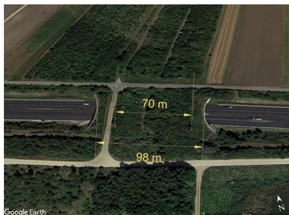
Ryc. 2.38. Zagospodarowanie strefy najścia i migracji na sześciu zespolonych mostach krajobrazowych, wybudowanych nad autostradą A4 na długości ok. 5 km, o jednakowej szerokości i konstrukcji, z bardzo podobnym układem dróg lokalnych i różnym zagospodarowaniem powierzchni mostów Źródło: zdjęcie satelitarne z Google Earth [163].
