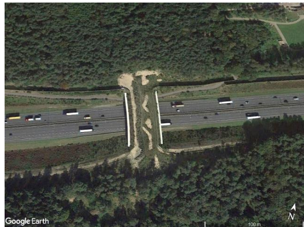
Ryc. 2.40. Zagospodarowanie terenu zachodniego mostu zielonego wybudowanego w małym kompleksie leśnym przeciętym autostradą A28 Źródło: zdjęcie satelitarne z Google Earth [163].
