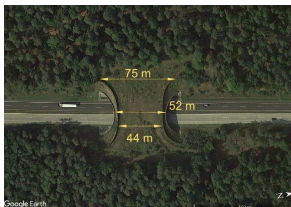
Ryc. 3.31. Wymiary konstrukcji parabolicznej: szerokość strefy najścia – 75 m, szerokość obiektu – 52 m, faktyczna szerokość przejścia – 44 m
