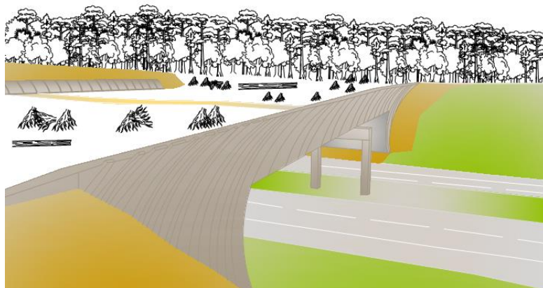
Ryc. 3.76. Kształt konstrukcji obiektu i zagospodarowanie jego powierzchni, będące kolejnym elementem doświadczalnym (most zielony Leusderheide nad autostradą A28)
