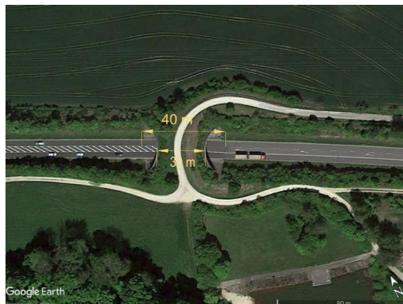
Ryc. 4.60. Most zielony Nesselwangen (szerokość w strefie najścia – 40 m, największa szerokość obiektu – 30 m, faktyczne szerokości w strefie migracji – 6 i 10 m) Źródło: zdjęcie satelitarne z Google Earth [163].
