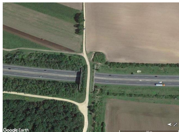
Ryc. 4.53. Przykład zagospodarowania strefy migracji przejścia pomiędzy dużym kompleksem leśnym a terenem rolniczym Źródło: zdjęcie satelitarne z Google Earth [163].
