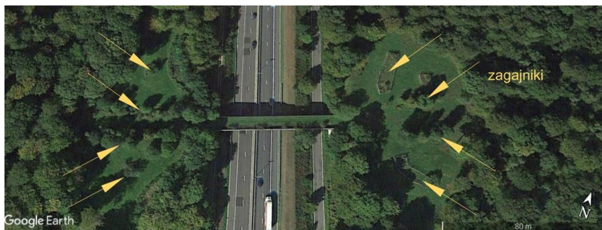
Ryc. 5.19. Przykład zagospodarowania powierzchni strefy przywabiania na przejściu zlokalizowanym na terenie leśnym Źródło: zdjęcie satelitarne z Google Earth [163].
