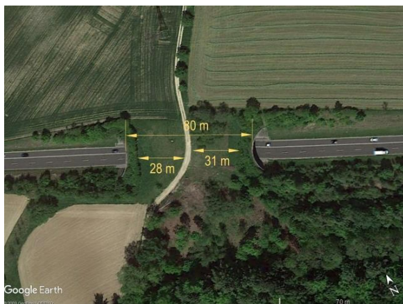
Ryc. 4.34. Most zielony Hirschweg (szerokość w strefie najścia – 89 m, największa szerokość obiektu – 80 m, faktyczna szerokość strefy migracji – 28 i 31 m) Źródło: zdjęcie satelitarne z Google Earth [163].
