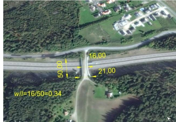
Ryc. 2.56. Podstawowe wymiary mostu zielonego i współczynnik ciasnoty względnej Źródło: zdjęcie satelitarne z Google Earth [163].
