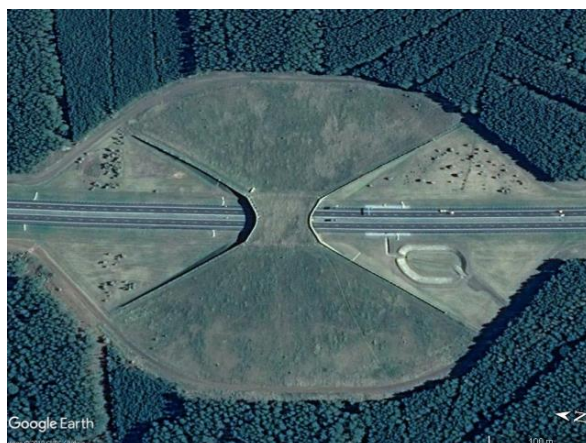
Ryc. 5.5. Powierzchnia wykarczowanego lasu przy przejściu górnym (droga ekspresowa S3 w Polsce, koło wsi Popowo) Źródło: zdjęcie satelitarne z Google Earth [163].
