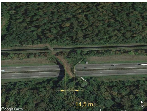
Ryc. 2.33. Drugie od zachodu przejście górne, z drogą leśną o nawierzchni gruntowej (stan jesienią i latem), wybudowane we Francji nad autostradą A36
