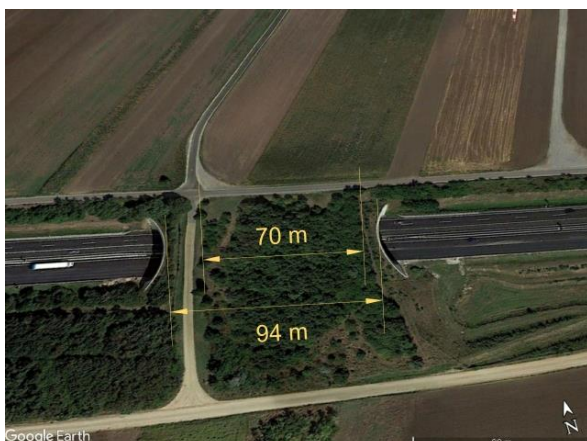
Ryc. 2.38. Zagospodarowanie strefy najścia i migracji na sześciu zespolonych mostach krajobrazowych, wybudowanych nad autostradą A4 na długości ok. 5 km, o jednakowej szerokości i konstrukcji, z bardzo podobnym układem dróg lokalnych i różnym zagospodarowaniem powierzchni mostów Źródło: zdjęcie satelitarne z Google Earth [163].
