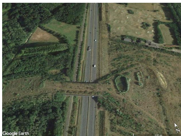
Ryc. 2.22. Przykład uwzględnienia warunków krajobrazu hydrograficznego na przejściu wybudowanym w Holandii nad autostradą A73, w pobliżu wsi Waterloo Beesel Źródło: zdjęcie satelitarne z Google Earth [163].
