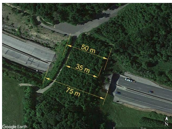
Ryc. 3.11a. Przykładowe proporcje charakterystycznych szerokości na bardzo bogato zagospodarowanym zielenią przejściu górnym w Czechach Źródło: zdjęcie satelitarne z Google Earth [163].
