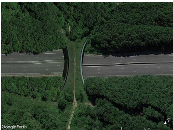
Ryc. 5.9. Przykład zagospodarowania powierzchni strefy migracji obsianej trawą, przy zastosowaniu na krawężniach obiektu ekranów Źródło: zdjęcie satelitarne z Google Earth [163].
