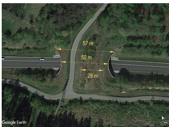
Ryc. 4.61. Most zielony Schwarzgraben (szerokość w strefie najścia – 57 m, największa szerokość obiektu – 50 m, faktyczna szerokość w strefie migracji – 29 m) Źródło: zdjęcie satelitarne z Google Earth [163].
