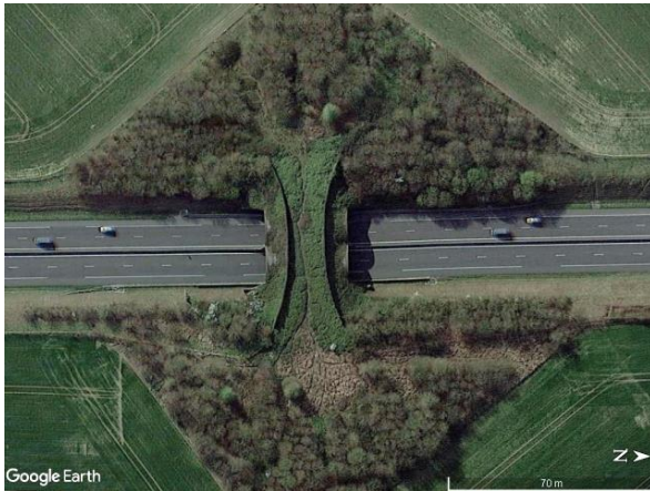
Ryc. 4.44. Zagospodarowanie przejścia, o szerokości 12 m, wybudowanego w terenie rolniczym, z bogato zagospodarowaną strefą buforową Źródło: zdjęcie satelitarne z Google Earth [163].
