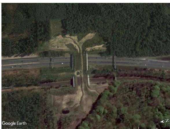
Ryc. 3.44. Strefa buforowa na moście zielonym Zwaluwenberg wybudowanym nad autostradą A27; stan dwa lata po budowie w 2014 r. Źródło: zdjęcie satelitarne z Google Earth [163].
