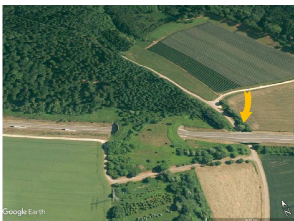
Ryc. 2.52. Przykład dobrego planowania lokalizacji mostu krajobrazowego na terenie rolniczym, zapewniającego komunikację drogową po pobliskiej drodze Źródło: zdjęcie satelitarne z Google Earth [163].
