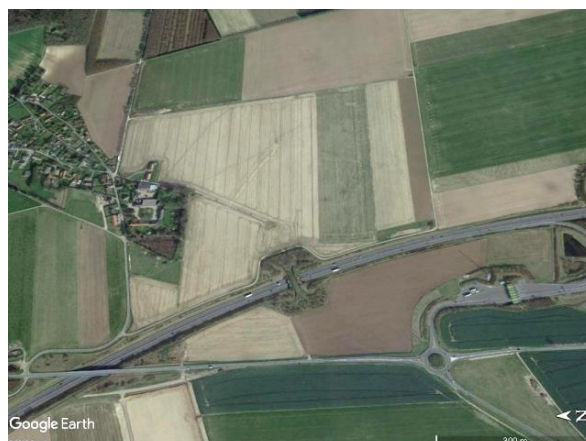
Ryc. 3.50. Nowo utworzona strefa buforowa mostu zielonego, wybudowanego na terenie rolniczym z niewielką deniwelacją terenu, powstała z jednego zagajnika Źródło: zdjęcie satelitarne z Google Earth [163].
