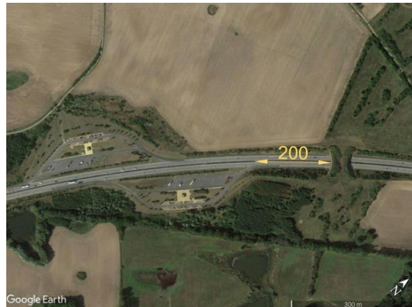
Ryc. 2.45. Przykład lokalizacji przejścia samodzielnego w odległości ok. 200 m od MOP w Niemczech Źródło: zdjęcie satelitarne z Google Earth [163].
