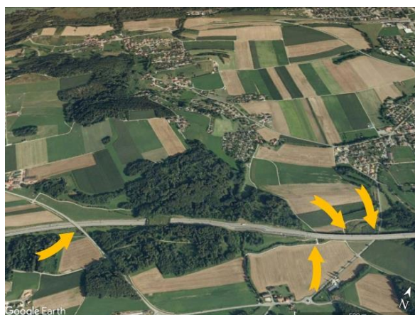
Ryc. 2.53. Przykład dobrej lokalizacji mostu krajobrazowego w kompleksie leśnym, zapewniającego poprzeczną komunikację drogową po wiadukcie i pod estakadą w ciągu trzech dróg lokalnych Źródło: zdjęcie satelitarne z Google Earth [163].
