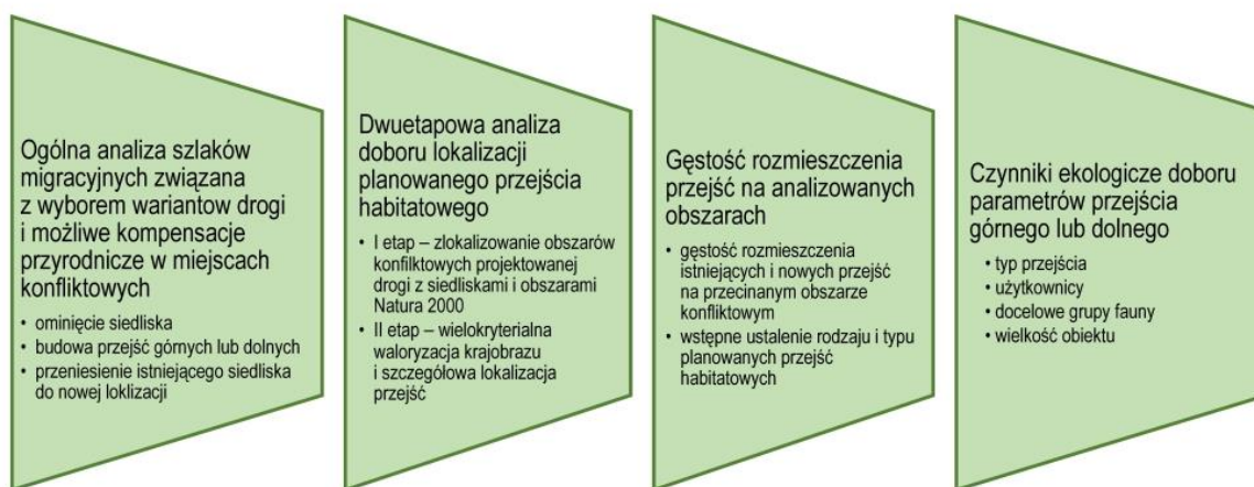
Ryc. 2.1. Schemat głównych czynników ekologicznych uwzględnianych podczas projektowania przejść dla zwierząt dziko żyjących
