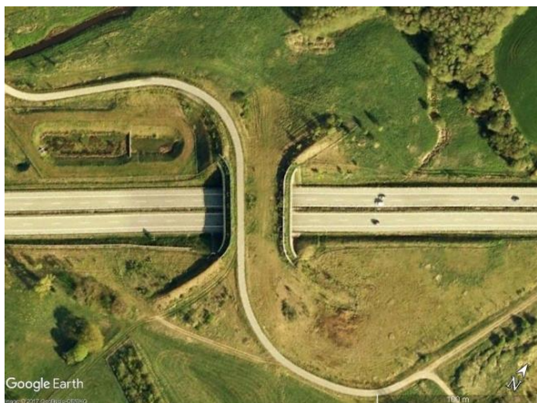
Ryc. 3.82 Ekran betonowy połączony szczelnie z wałami ziemnymi, stanowiącymi równocześnie naprowadzenia (stan z 2008 r. – cztery lata po budowie) Źródło: zdjęcie satelitarne z Google Earth [163].
