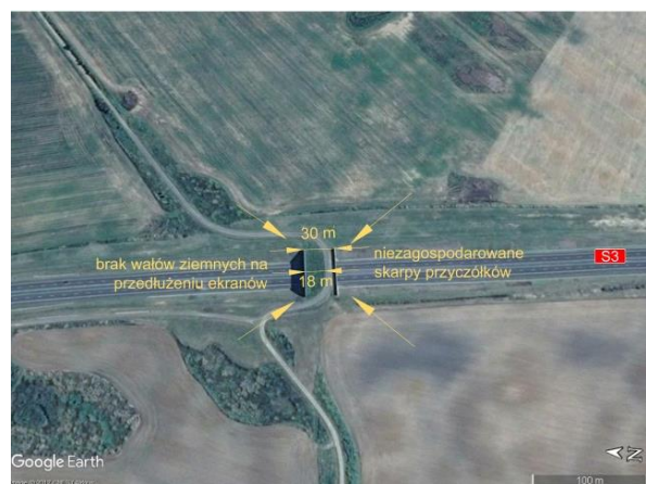
Ryc. 4.29. Przejście górne nad drogą ekspresową S3 w Polsce koło Krzemlina, z nieprawidłowo wytrasowaną drogą lokalną na przejazdy rolnicze Źródło: zdjęcie satelitarne z Google Earth [163].
