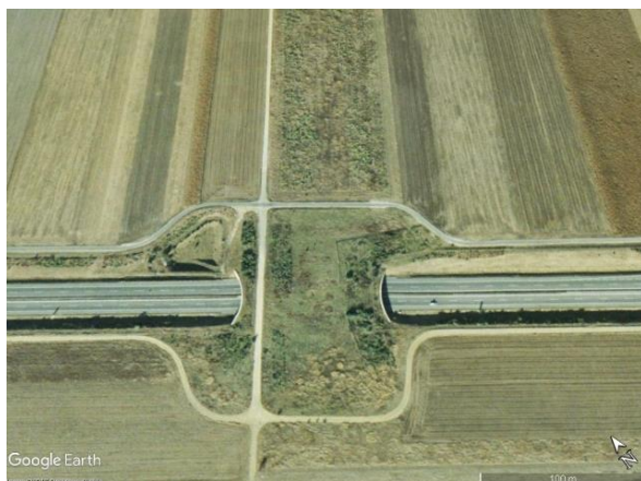
Ryc. 2.37. Zmiany zagospodarowania strefy najścia i migracji w ciągu 14 lat na jednym z mostów wybudowanych nad autostradą A4 w Austrii
