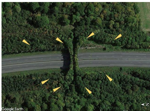
Ryc. 5.23. Przykład zagospodarowania powierzchni strefy naprowadzająco-osłonowej na terenie leśnym Źródło: zdjęcie satelitarne z Google Earth [163].
