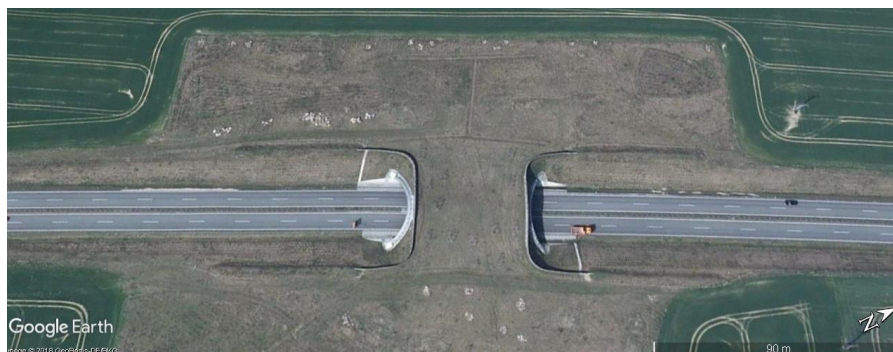
Ryc. 4.70. Przykład początkowego zagospodarowania powierzchni mostu i otoczenia w postaci kopców ułożonych z dużych głazów, widocznych w strefach: dojścia, najścia i migracji; stan mostu zielonego w 2009 r. Źródło: zdjęcie satelitarne z Google Earth [163].
