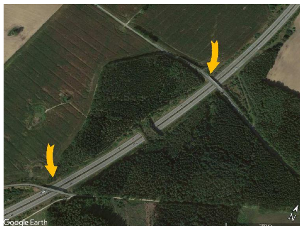
Ryc. 2.51. Przykład dobrej lokalizacji mostu zielonego w kompleksie leśnym, zapewniającego komunikację po pobliskich wiaduktach drogowych Źródło: zdjęcie satelitarne z Google Earth [163].
