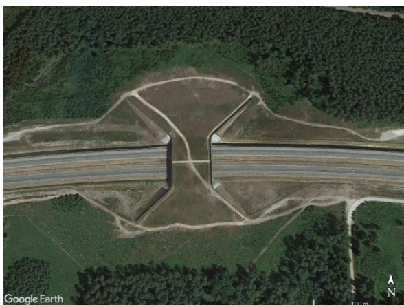
Ryc. 5.4. Powierzchnia wykarczowanego lasu przy przejściu zespolonym i nieprawidłowy przebieg drogi lokalnej (autostrada A4 w Polsce, koło wsi Bratkowice) Źródło: zdjęcie satelitarne z Google Earth [163].
