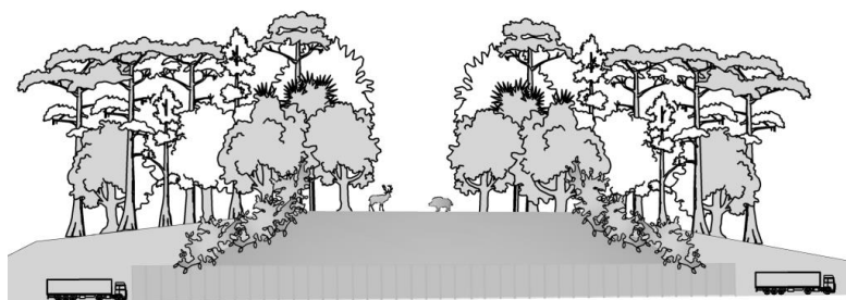
Ryc. 3.16. Zwierzęta, korzystając z przejścia górnego wybudowanego nad drogą zlokalizowaną w niewielkim wykopie (zob. ryc. 3.14 i 3.15), widzą przedłużenie naturalnego środowiska po drugiej stronie tego przejścia, w związku z czym szybciej dane przejście zaakceptują
