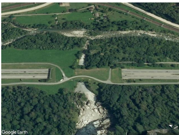
Ryc. 2.27. Przejście z bardzo wysoką oceną wielokryterialną i bardzo funkcjonalne pomimo lokalizacji na jego powierzchni trzech dróg i dwóch skrzyżowań Źródło: zdjęcie satelitarne z Google Earth [163].
