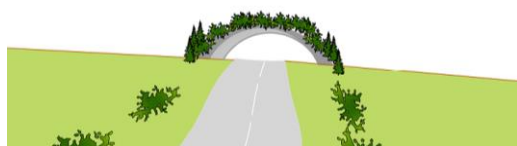
Ryc. 3.17a. Niezalecana niweleta przejścia górnego wyniesiona ponad otaczający teren i skonfigurowana w łuku pionowym wypukłym Źródło: opracowanie graficzne Dominik Kacprzak.
