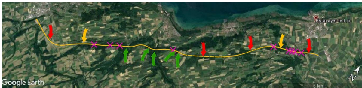
Ryc. 2.42. Przykład wybudowania 20 obiektów inżynierskich na szlaku migracyjnym, o długości 16 km, w Szwajcarii w okolicy jeziora Neuchâtel (strzałkami czerwonymi oznaczono położenie czterech tuneli, strzałkami pomarańczowymi – lokalizację dwóch mostów krajobrazowych, o szerokości 110 i 200 m, strzałkami zielonymi – lokalizację pięciu estakad, krzyżykiem różowym – położenie dziewięciu przejść dolnych zespolonych) Źródło: zdjęcie satelitarne z Google Earth [163].
