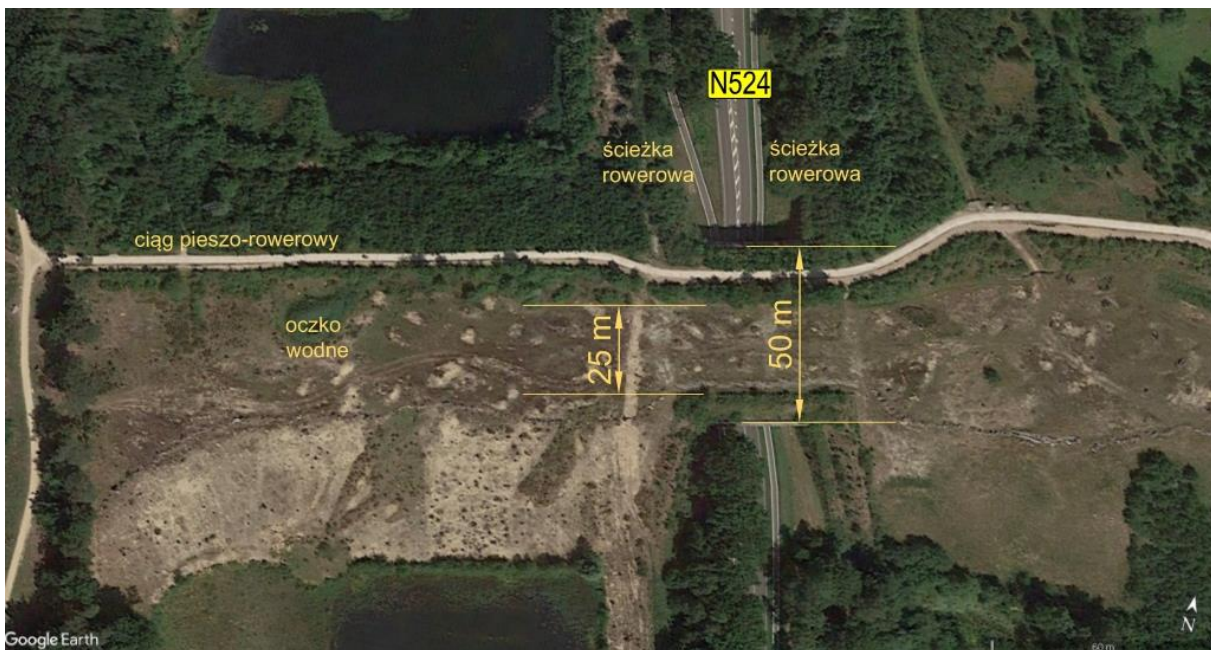
Ryc. 2.66. Najdłuższe przejście – część zachodnia nad drogą N524 (stan roślinności osiem lat po wybudowaniu) Źródło: zdjęcie satelitarne z Google Earth [163].
