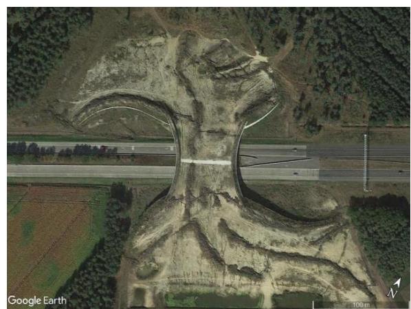
Ryc. 3.29f. Przejście Witrijt Kampengrens nad autostradą E34 w Holandii, o szerokości najścia 100 m, szerokości obiektu 67 m (faktyczna szerokość przejścia wynosi 51 m)
