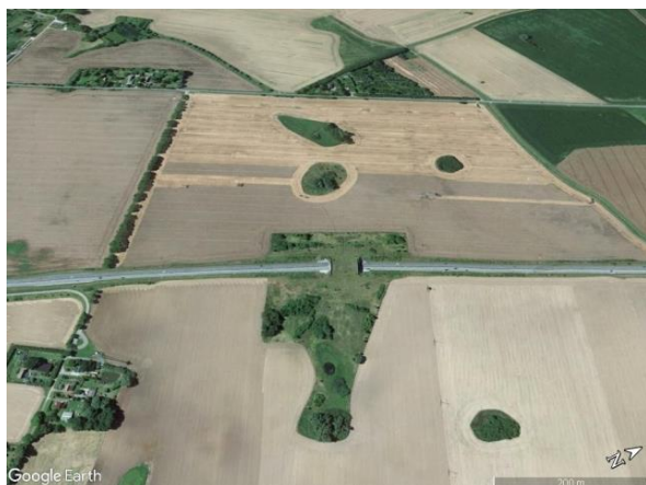
Ryc. 3.51. Nowo utworzona strefa buforowa mostu zielonego, wybudowanego na otwartym terenie rolniczym nad drogą B96, powstała z połączenia niewielkich zagajników wraz z oczkiem wodnym Źródło: zdjęcie satelitarne z Google Earth [163].
