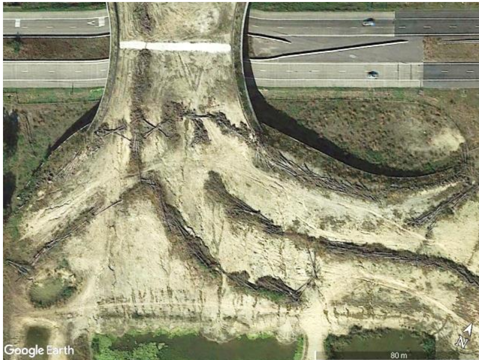
Ryc. 4.5. Zagospodarowanie południowego terenu strefy najścia i strefy migracji na przejściu górnym Kampengrens Źródło: zdjęcie satelitarne z Google Earth [163].
