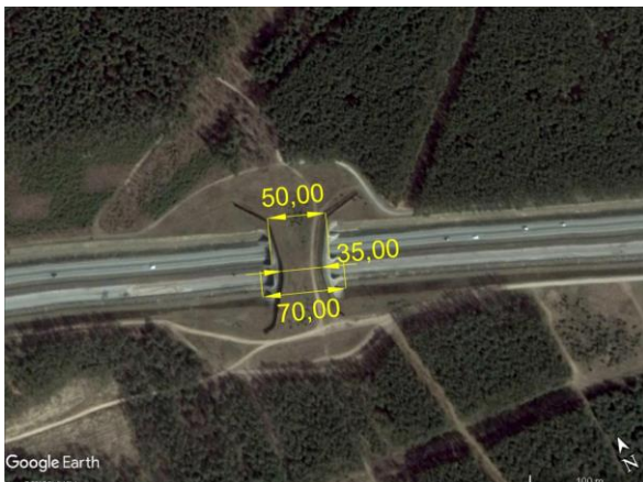
Ryc. 3.4. Różnica dwukrotna długości konstrukcji w odniesieniu do faktycznej szerokości przejścia (przejście w Polsce nad autostradą A2)
