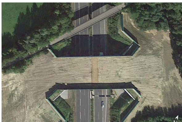
Ryc. 4.86. Rezultaty stopniowo wykonywanych prac rewaloryzacyjnych mających na celu uzupełnienie nasadzeń drzew, budowę oczek wodnych w strefie migracji i najścia, związanych m.in. z zapewnieniem ciągłości tras przelotu nietoperzy Źródło: zdjęcie satelitarne z Google Earth [163].
