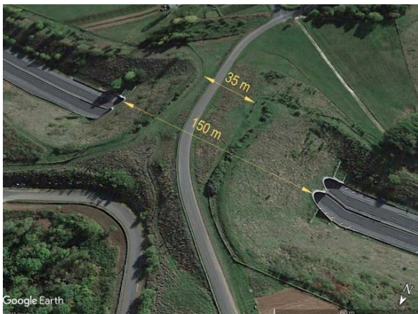
Ryc. 4.50. Przejście zespolone, o łącznej szerokości faktycznej 35 m, z bardzo słabo zagospodarowaną strefą migracji (szerokość obiektu wynosi 150 m) Źródło: zdjęcie satelitarne z Google Earth [163].
