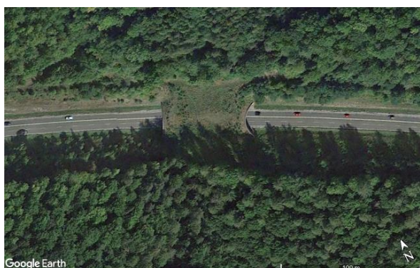
Ryc. 4.84. Przykład zmiany zagospodarowania terenu przejścia i samoistnego ekspansyjnego rozwoju okolicznej roślinności na powierzchni przejścia, wałach ziemnych i skarpach wykopu, odgradzających najścia na obiekt Źródło: zdjęcie satelitarne z Google Earth [163].
