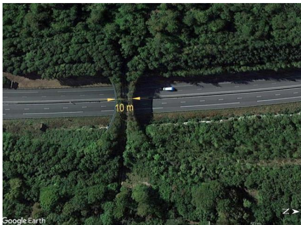
Ryc. 4.46. Zagospodarowanie przejścia, o szerokości 10 m, wybudowanego w terenie leśnym, z bardzo bogato zagospodarowaną strefą buforową Źródło: zdjęcie satelitarne z Google Earth [163].
