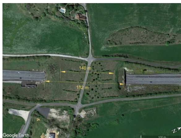
Ryc. 4.27. Przykład przejścia górnego wybudowanego nad autostradą A20 we Francji (szerokość obiektu – 192 m, szerokość łącznego przejścia – 128 m) Źródło: zdjęcie satelitarne z Google Earth [163].
