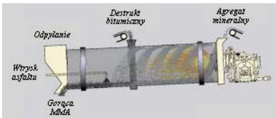
Rys. 1. Bęben suszący wraz z mieszalnikiem w technologii produkcji ciągłej MMA Fig. 1. Drying drum with mixer in asphalt constant production technology
